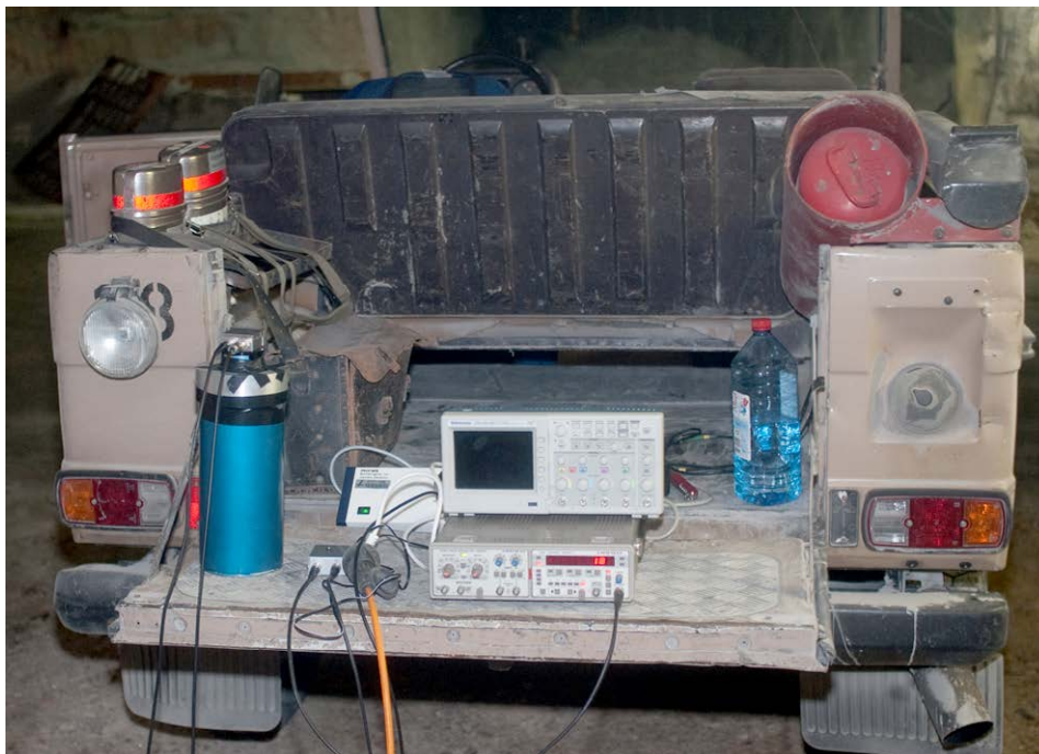
Abbildung 22: Typischer Messaufbau der Absorptionsmessungen von Gestein.
