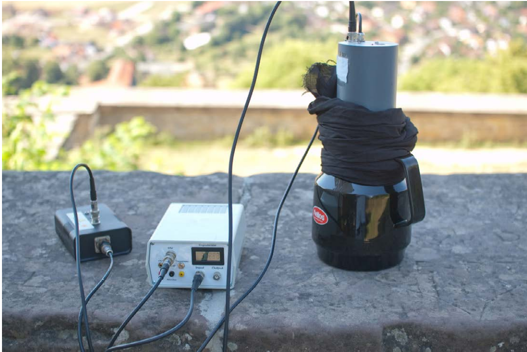
Abbildung 9: Messsituation mit der mobilen Kamiokanne.
