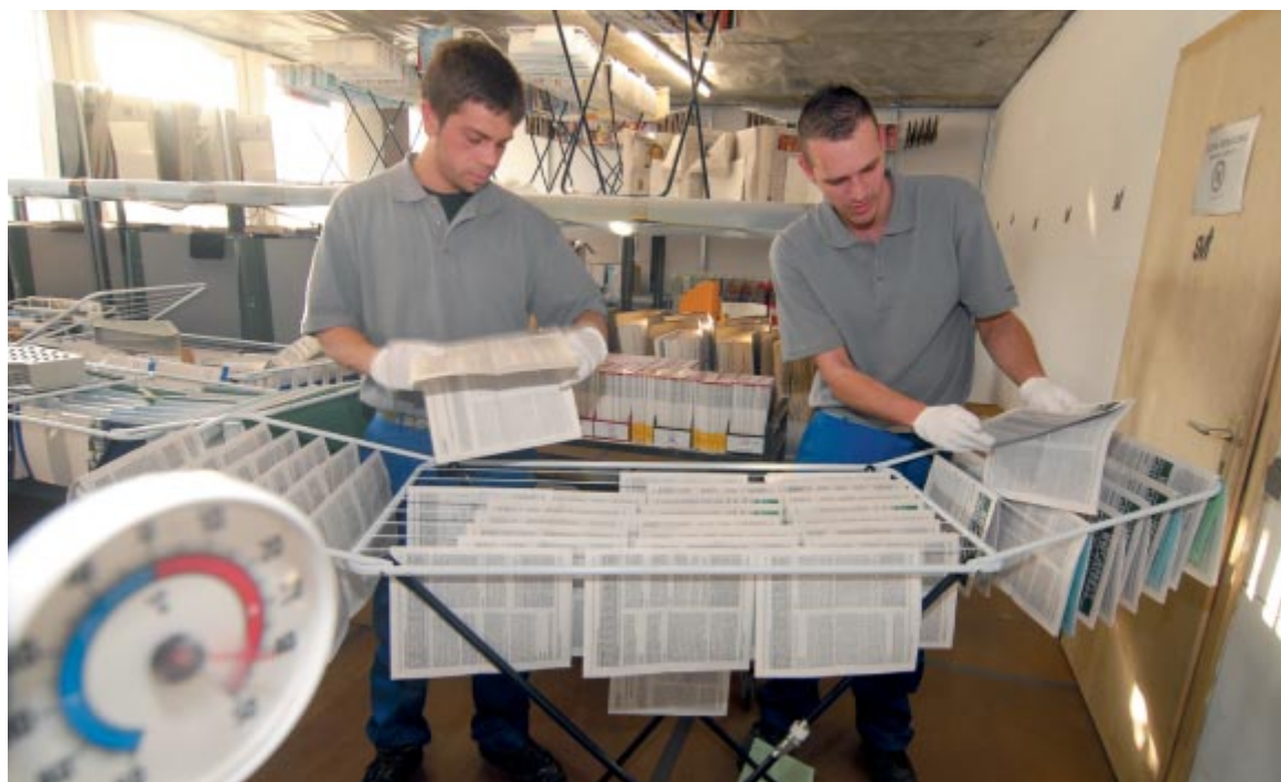
Vorbereitung für die Geruchsneutralisation der gereinigten Bände: Ausgefächert werden Bücher und Zeitschriften 36 bis 48 Stunden zum „Ausgasen“ gebracht. Dazu wird so genannter Singulett-Sauerstoff eingesetzt (Foto: Christina Hinzmann)
