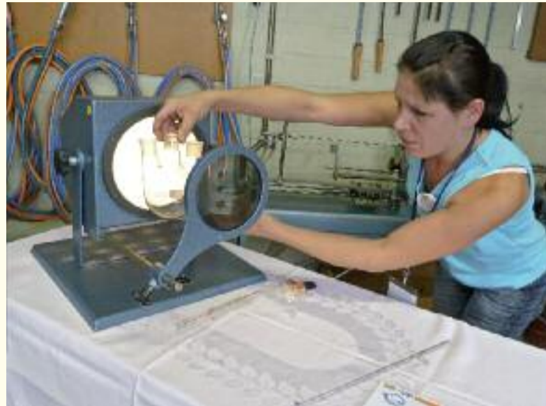
Spannungen im Glas erkennen: Nicole Schrickel zeigt, wie es funktioniert.
